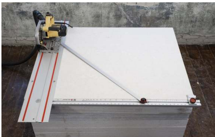
3. Skal plader skæres med sav i venstre side, vendes hovedstakken som billedet illustrerer. Bemærk at mål og grader i dette tilfælde aflæses på hovedet.
