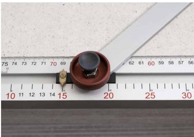
5. Bemærk at når vinklerne ændres væk fra de 90, opstår der en misvisning på hovedstakken lineal. Misvisningens størrelse er angivet over gradstallet. På billedet ses eksempelvis en vinkel på 15, og over gradstallet er det angivet med et lille 10 tal, at snittets ønskede mål er blevet 10 mm længere.
