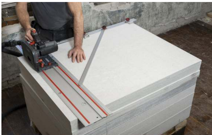
1. Angle. Design vinkelsættet vises her til brug sammen med føringsstav. Føringsstakken passer til alle dyksave.
