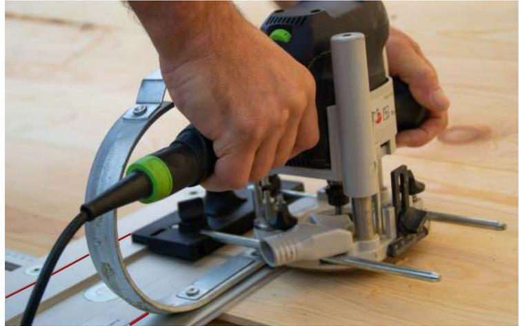
8. Passen Sie die Tiefe der Oberfräse und den Abstand zur Führungsschiene an. Denken Sie daran, den Anschlag an der Oberfräse auf die Unterlage auszurichten, und drehen Sie am besten die Geschwindigkeit der Oberfräse herunter, damit der Rinnenhalter nicht abgebrannt wird.
