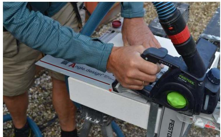
**6.** Durch den Einsatz einer Schwertsäge lassen sich auch größere Teile wie Brettschichtholz oder Bausteine zurichten. Für Porenbeton, Wellasbest oder Blähton hat Angle.design eine spezielle Kette, TR 401, entwickelt.
