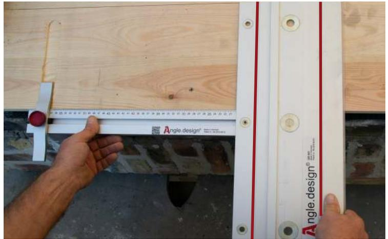
10. Drehen Sie den Anschlag um und stellen Sie den gewünschten Abstand zwischen den Rinnenhaltern ein. Setzen Sie den Abstandshalter in die erste Ausfräsung ein, um den Abstand zur nächsten Ausfräsung zu halten. Wenn Sie zwischen den Rinnenhaltern einen größeren Abstand als 62 cm wünschen, kann die Hauptschiene mit 121 cm verwendet werden.
