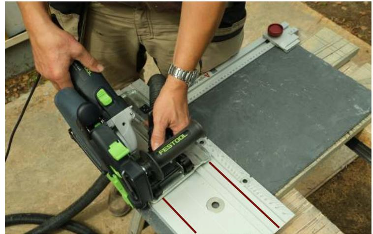
**4.** Für Wiederholungen empfiehlt es sich, den Endanschlag zu verwenden. Hier wird der Endanschlag für das Zurichten von Schieferplatten verwendet. Beim Schneiden von Naturschiefer oder Steinplatten muss eine geeignete Diamanttrennscheibe verwendet werden.
