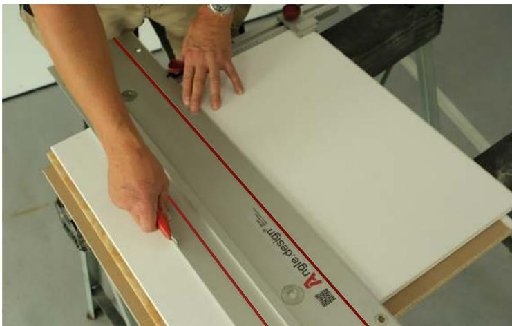
**5.** Wenn Sie die Führungsschiene drehen, eignet sich die Schiene zum Schneiden mit einem Teppichmesser. Die Messlinie auf der Hauptschiene passt weiterhin.
