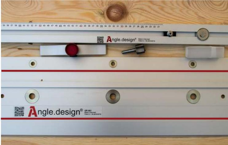
7. Der Winkelanschlag kann auch als Rinnenhalterfräser verwendet werden. Das Set enthält einen 26-mm-Nutenfräser, der für die meisten Rinnenhalter geeignet ist. Bei Bedarf kann problemlos ein breiterer Rinnenhalter verwendet werden.
