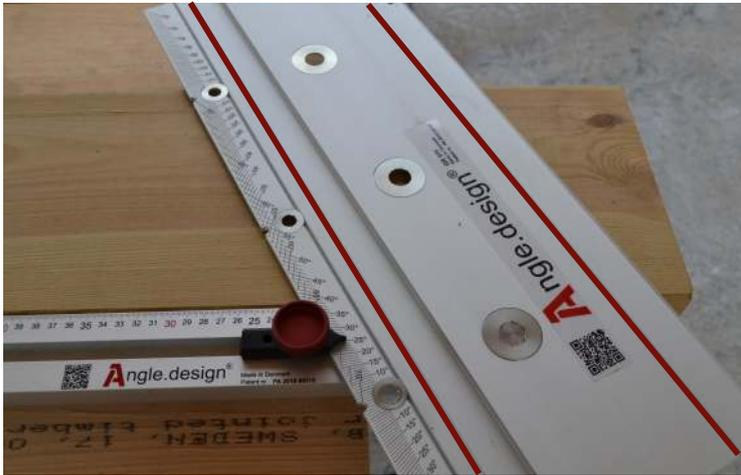
**3.** Der Winkelanschlag kann weitgehend anstelle einer Kappsäge verwendet werden. Stellen Sie einfach die Grade ein und schneiden Sie das Werkstück. Kann als Abfasungswinkel verwendet werden, danach können Sie das Werkstück direkt schneiden.
